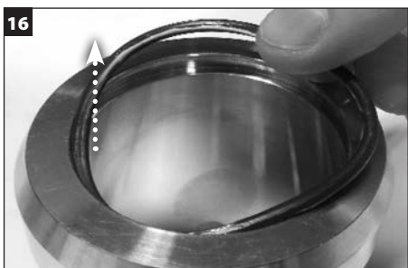
Verwijder de O-ring (V) van de as van de cilinder en gooi hem weg.
