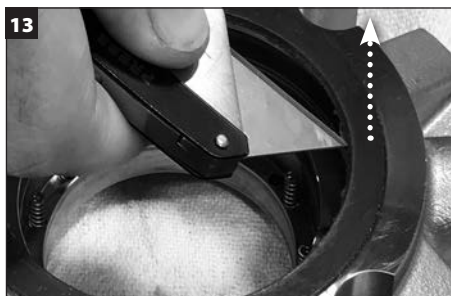
Verwijder de pakking op de voorkant van de pakkingbus van het drukstuk en gooi hem weg.
